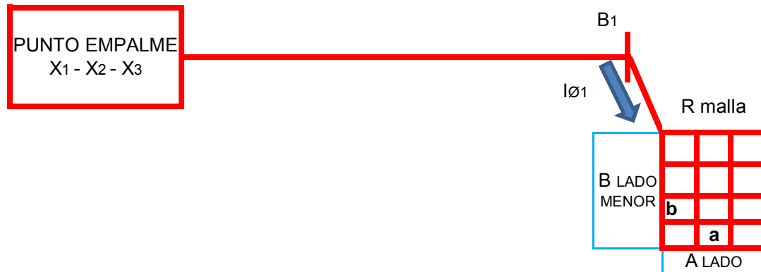
Fig. g) La figura muestra un sistema simplificado de cortocircuito en la barra B1.
